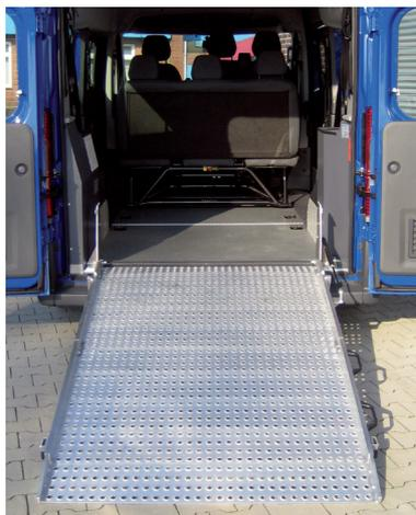
Abgeseenktes Fahrzeug zur Aufnahme der Fahrgäste bereit.
